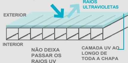
As chapas alveolares Glanze incorporam uma camada coextrudada de proteção UV, aplicada de forma uniforme em toda a superfície e com a porcentagem ideal para evitar o amareloamento e a perda de luminosidade ao longo do tempo. Graças a essa tecnologia, garantem alta durabilidade e possuem 10 anos de garantia sobre a transmissão de luz.
