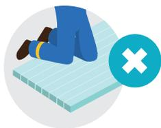
No arrodillarse sobre la plancha, ya que las cargas no distribuidas causan deformación en el producto.
